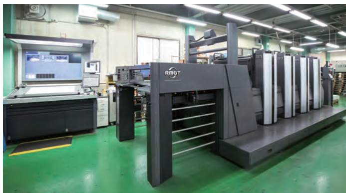
LED-UV 乾燥装置搭載 A全判オフセット印刷機 RMGT 940ST-4 (大画面のプレスインフォメーションディスプレイを装備)
