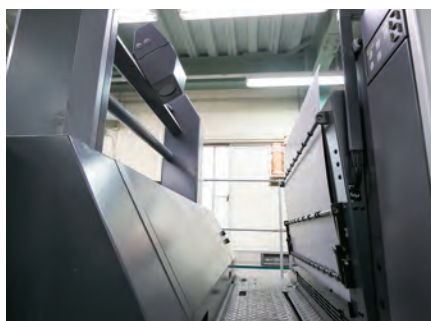
不良紙発生を検査する、インラインの品質検査装置
